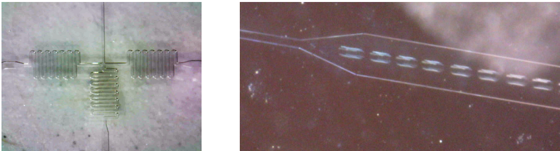
Fig.8 : (a) Détail de la puce (à gauche) et gouttes générées par dépression dans le canal (à droite).
