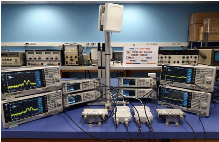
Fig.2. Montage simulant un site radio à l'aide d'une antenne directive indoor, de générateurs CW, d'analyseurs de spectre et de composants de filtrage et de couplage à cavités.
