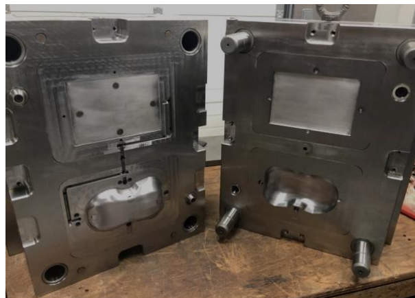
Fig.8. Le moule d'injection que nous avons conçu pour réaliser le surmoulage de dispositifs IME. Il dispose de deux empreintes : une empreinte plane dite plaque et une empreinte 3D dite la voiture. On peut basculer d'une empreinte à l'autre en fonction des besoins. Pour assurer le bon maintien des films lors du surmoulage, des trous d'aspiration par venturi sont disposés aux bords des empreintes. L'injection peut de plus se faire en deux points, que l'un peut choisir en tournant simplement un robinet.
