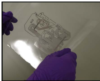
Fig.3. Exemple d'impression de lignes conductrices par technologie d'impression gouttes à gouttes sur un film plastique biodégradable.
