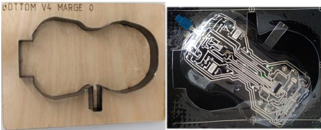
Fig.7. L'outil de détourage conçu spécialement pour la découpe des films mis en forme en 3D avec le moule « voiture » et un exemple de film thermoformé après détourage
