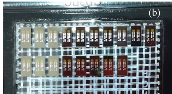
Fig.4. Layout du circuit de management puissance en (a) qui comprend 2 canaux indépendant et un pad pour la connexion au MEMS. Les échantillons des circuits fabriqués en GaN en (b).
