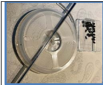
c) Conditionnement des composants CMS : rouleau, barrettes ou vrac
