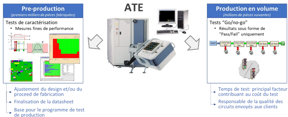
Fig.2. Les deux types de test réalisés dans l'environnement industriel : (1) le test de caractérisation sur les premiers milliers de pièces fabriquées, (2) le test de production en volume sur les millions de pièces suivantes.
