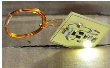
Fig.1. Schéma électrique et photographie du récepteur LED sans fil. J1/J2 : Bornes de connexion de la bobine réceptrice (5 spires, L=878 nH, \varnothing 2 cm, fil émaille de 0.54mm). C1-C6 : Condensateurs céramique pour l'ajustement de la fréquence de résonance. D1, D2, D4, D5 : Pont de Graetz (diodes Schottky MBR0520LT1G). C7 (33 nF), C8 (10 nF) : Condensateurs de lissage. R1 (10 \Omega ) : Résistance de limitation de courant pour éviter un sur-courant dans LED en cas de transmission de grande puissance. D3 : LED blanche (JE2835AW) Diode basse consommation (typiquement une LED blanche). La diode utilisée s'allume dès 400 \mu A pour environ 2,6v.
