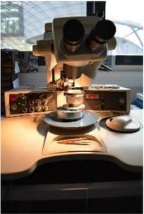
Machine pour microsoudures en aluminium
